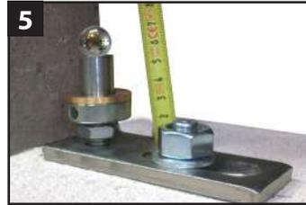
5 Mettre à la côte souhaitée le bas du portail par rapport au seuil (haut de la rondelle laiton si utilisée).
