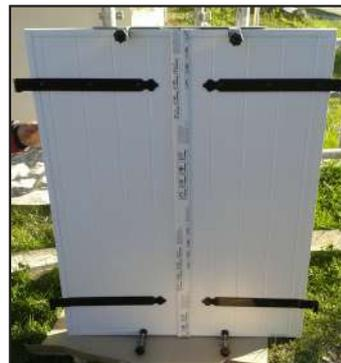
Volets PVC ou Alu assemblés par serrage. (On abîme pas le volet)
