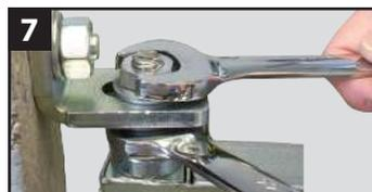
7 Serrer les 2 écrous-rondelles (clé de 22) en même temps (tout en vérifiant l'aplomb).
