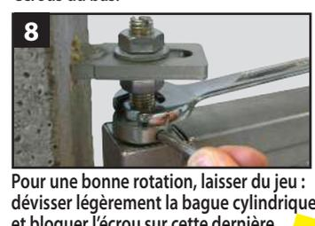
8 Pour une bonne rotation, laisser du jeu : dévisser légèrement la bague cylindrique et bloquer l'écrou sur cette dernière.
