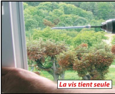
1. Grâce à sa tête hexagonale, la VIS-TOP tient seule sur l'embout 6 pans.
