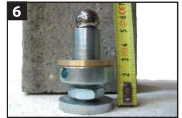
6 Mettre en place la rondelle laiton ou la bille.
