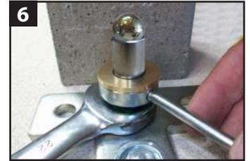
6 Pour maintenir la côte, bloquer l'ensemble (bague et écrou plat) avec la clé de 22 et la tige lisse.
