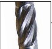
Moletage: diminution de la résistance au vissage.
