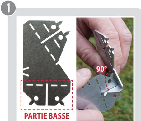
À l'aide d'un deuxième connecteur, former la **PARTIE BASSE** en pliant de chaque côté les deux ailettes à 90°.
