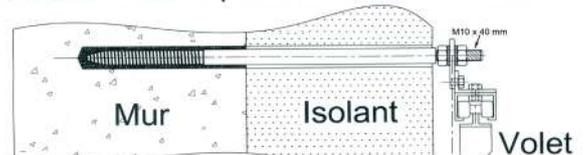
Attention : décalage entre la fixation haute et la fixation basse + ou - 2 cm
