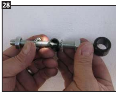
28 Dévisser les écrous et la tige filetée de la pièce de raccordement pour avoir du jeu.
