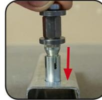
A l'aide d'un marteau, insérer l'ensemble dans le trou.
