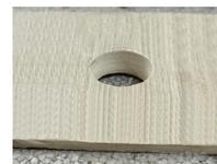
Trépan diamant - perçage
