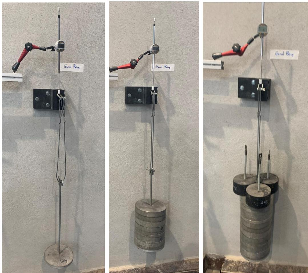
1<sup>re</sup> configuration : Bloc ITE + Gond à visser, avant et après essai chargement instantané :
