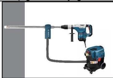
Sélectionner un foret creux approprié (voir tableau table B1) et le placer dans le marteau-perforateur.
