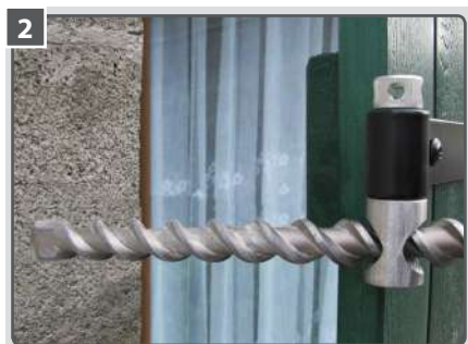
2 Percer au travers du gabarit de perçage.
